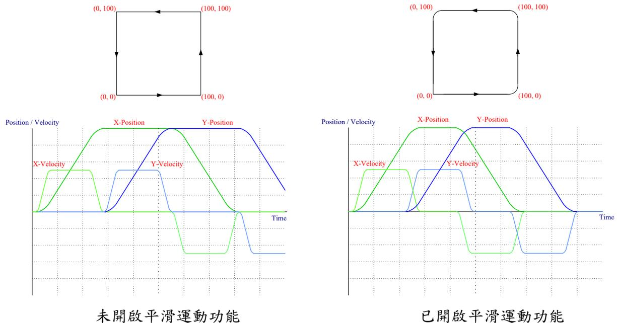
上圖顯示一等矩形軌跡經開啟平滑運動後之軌跡變化與運動情形。圖左未開啟平滑運動功能時，X 軸直線運動命令在減速停止後 Y 軸直線運動命令方才啟動；圖右當開啟平滑運動功能後，X 軸直線運動命令在開始減速時 Y 軸直線運動命令則同時加速啟動。故開啟平滑運動功能可有效縮短運動命令之執行時間，但亦會造成各筆運動命令之軌跡連接處的失真情況。
