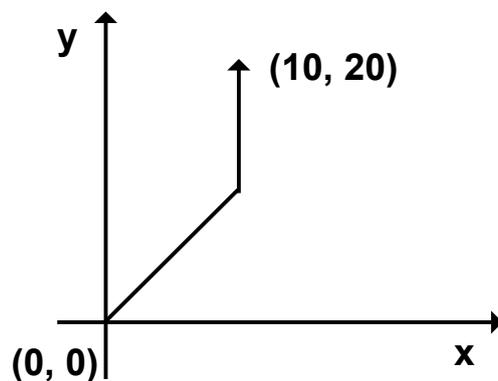
點對點運動採用不同動的運動方式，也就是各軸使用各自的速度運動，各軸在同時啟動後並不一定會同時到達目的點，這點與一般運動不同，一般運動使用同動的運動方式，各軸同時啟動後會同時到達目的點。
