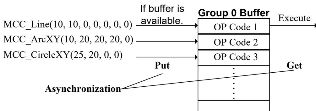
上圖顯示對 Group 0 運動命令緩衝區的操作過程，可看出屬於同一個 Group 的運動命令將被依序執行。因為各個 Group 擁有專屬的運動命令緩衝區，因此可同時執行屬於不同 Group 的運動命令，更詳細的說明請參考”*EPCIO Series 運動控制函式庫使用手冊 2.3 函式庫操作特性*”。
